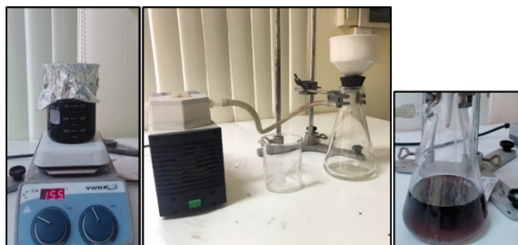
ຮູບທີ 2 ຂະບວນການສັງເຄາະທາດລະລາຍ Na 2 SiO 3 ຈາກເຖົ່າແກບ
